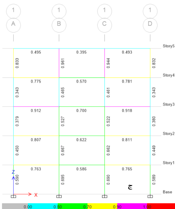
شکل ۴-۱، مقایسه نسبت نیرو به ظرفیت قاب بحرانی سازه ۵ طبقه با و بدون دیوار برشی فولادی؛ (الف) منظم بدون
