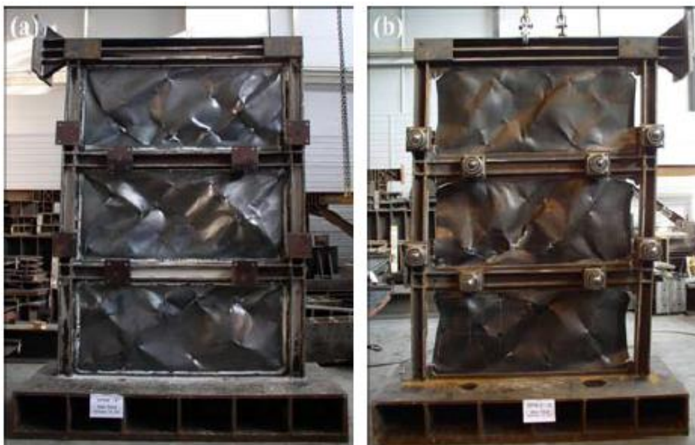
شکل ۲-۳۲، تغییر شکل نمونه‌های FSPW2 و FSPW4 در بارگذاری نهایی در تحقیق Choi و Park [۱۳]
