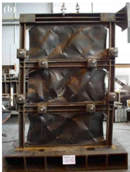
شکل ۲-۲۸، نمونه آزمایشگاهی با اتصال بخشی در تحقیق Choi و Park [۱۳]
