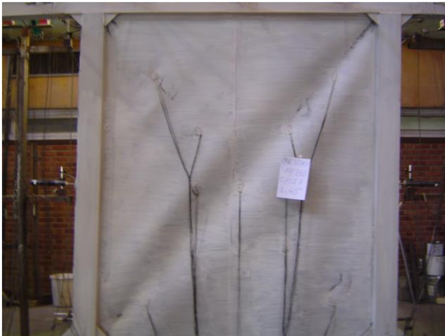
شکل ۱۹-۲، کمانش ورق در سیکل هجدهم در نمونه با ستون‌های 2UNP160 [۱۱]
