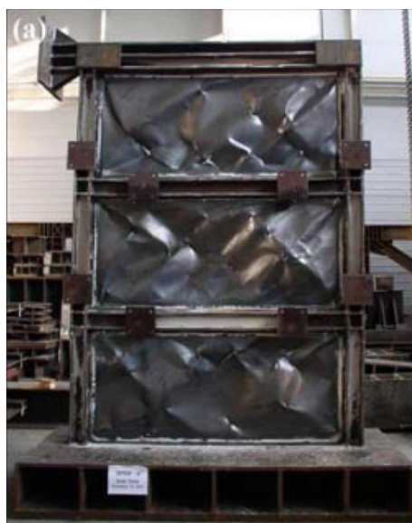
شکل ۲-۲۹، نمونه آزمایشگاهی با اتصال کامل در تحقیق Choi و Park [۱۳]
