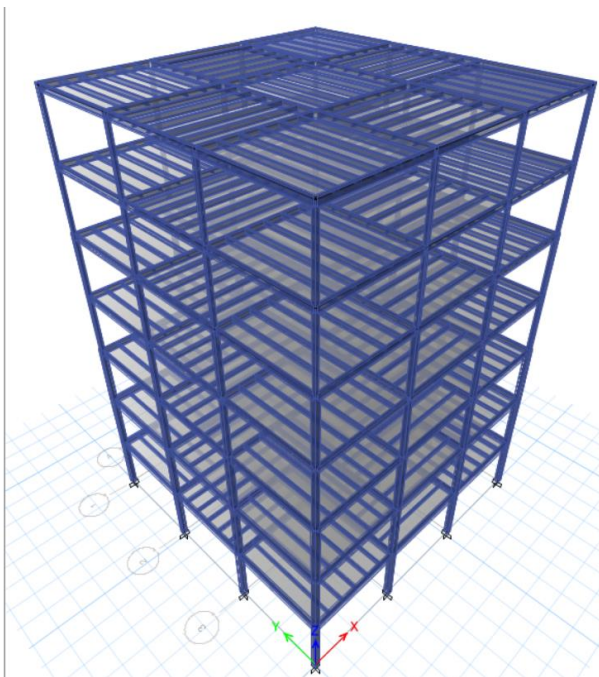
شکل ۱-۳، مدل سازی سازه های ۵ طبقه بصورت منظم و نامنظم در پلان
